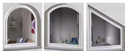
Die Befestigung des Spannrahmens am Fenster erfolgt meist ohne zu bohren über Einhängewinkel aus Edelstahl. Die rundumlaufenden Bürsten sorgen für eine insektensichere und schonende Abdichtung mit Entwässerungsfunktion an der Schnittstelle zwischen Fenster und Insektenschutz.
