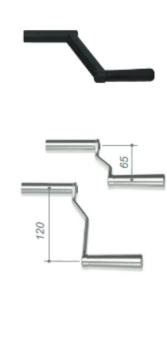
Die KINI-Innenöffner ersetzen bei Fensterläden den untern, bei hohen Türklappläden den mittleren Achspunkt. Anstelle der standardmäßig verwendeten Mauerkloben wird der Innenöffner mit einer Montagebohrung seitlich der Laibung durch die Wand geführt.
